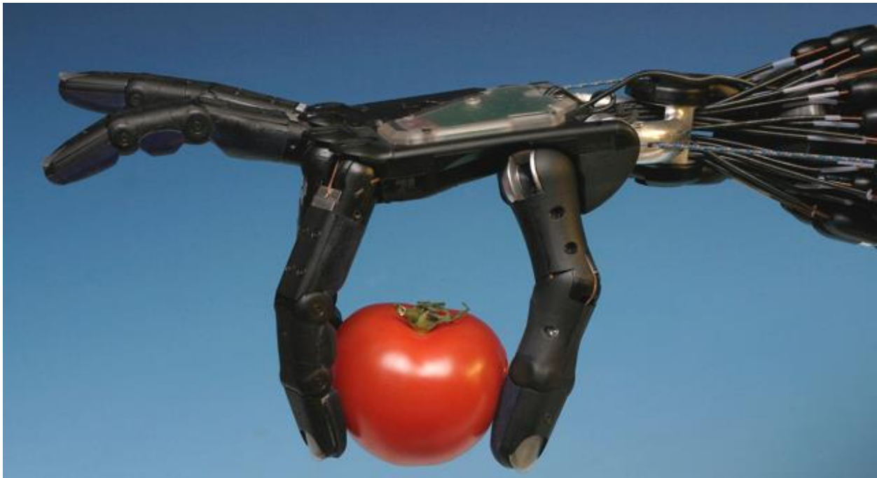
Σχήμα 4.27. Ένα ρομποτικό χέρι πιάνει με δύο δάχτυλα ένα εύθραυστο αντικείμενο [21]
